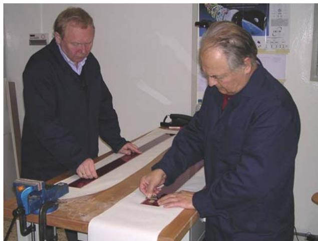
**Figura 3.18:** Pulitura dei vetri con la pittura acrilica ad alta resistività.
