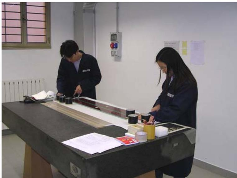
**Figura 3.21:** Incollaggio dei vetri con la pittura acrilica sui PCB.
