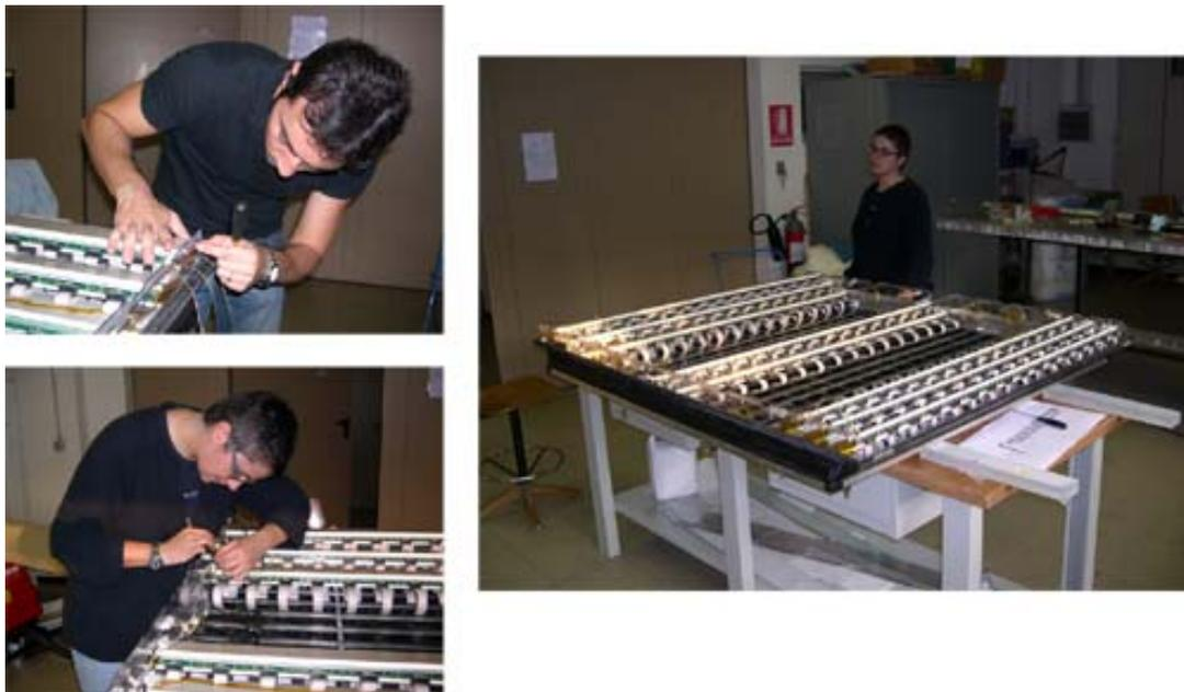
**Figura 4.28:** Dettagli della fase di assemblaggio delle MRPC nel modulo.
