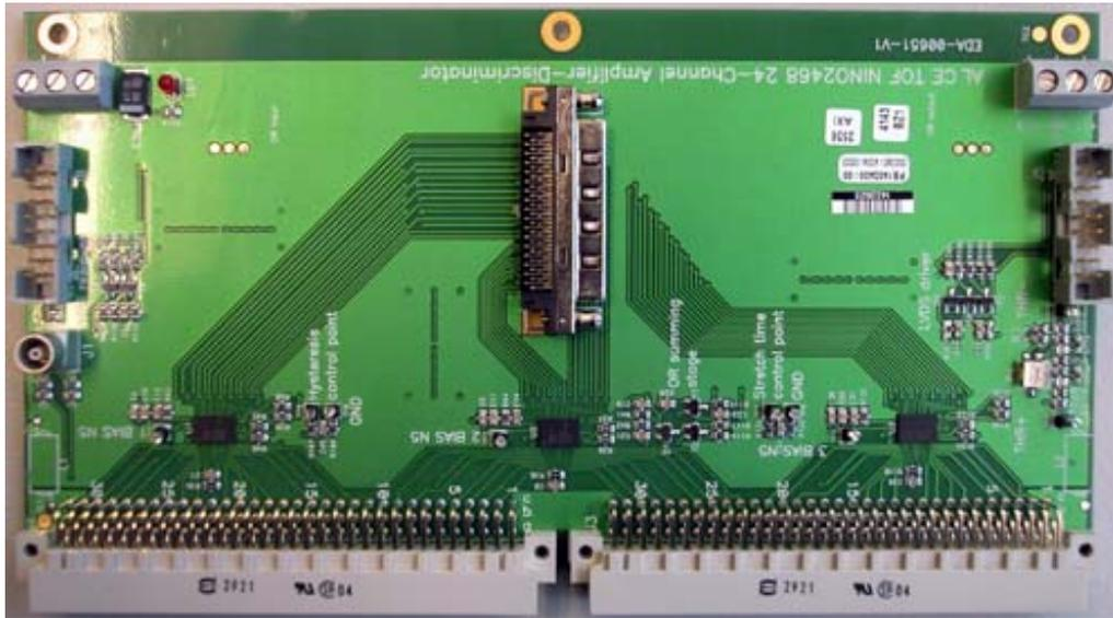
**Figura 3.28:** Fotografia dell'ultima versione della scheda di *front-end* con tre chip NINO-ASIC impacchettati ed il connettore VHDCI SCSI-micro-D per i cavi Skewclear della Amphenol.
