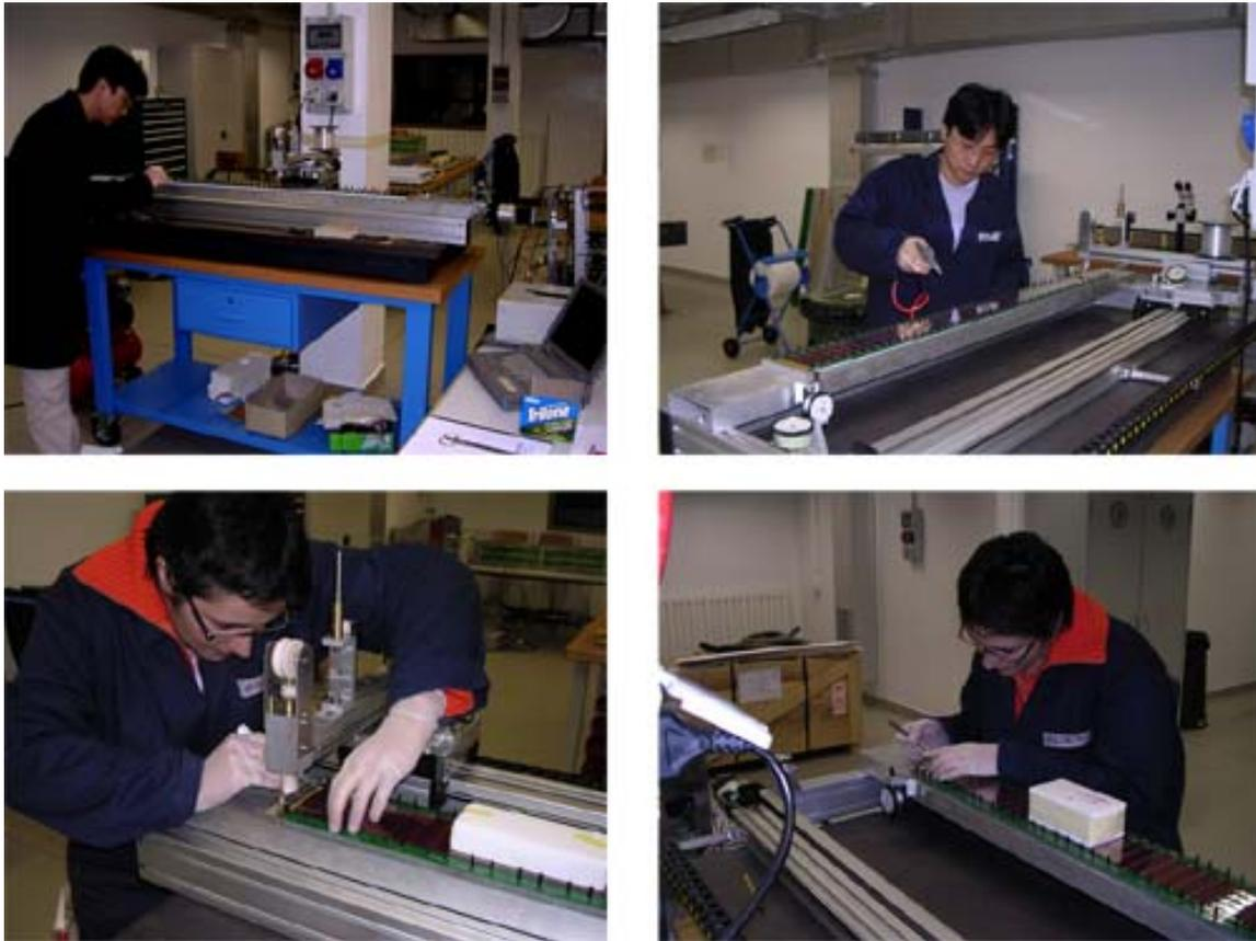
**Figura 3.23:** Dettagli della fase di stesura del filo da pesca con la macchina automatica (Penelope).
