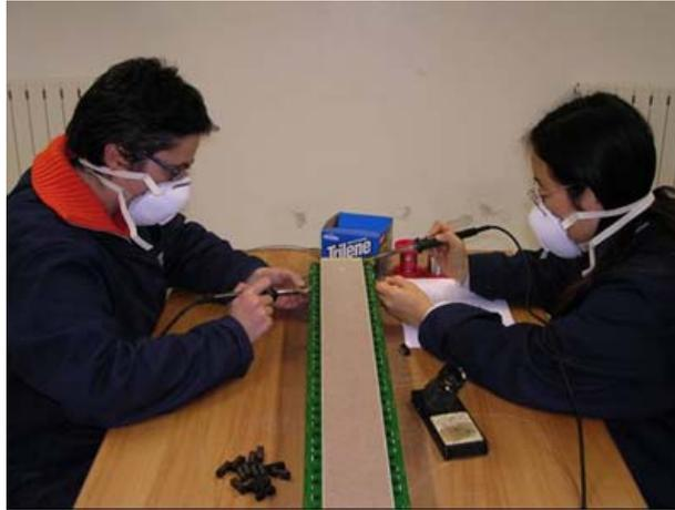
**Figura 3.24:** Fase finale della saldatura dei pin di trasmissione dei segnali dai catodi all'anodo. Per ogni MRPC sono necessarie 1664 saldature.
