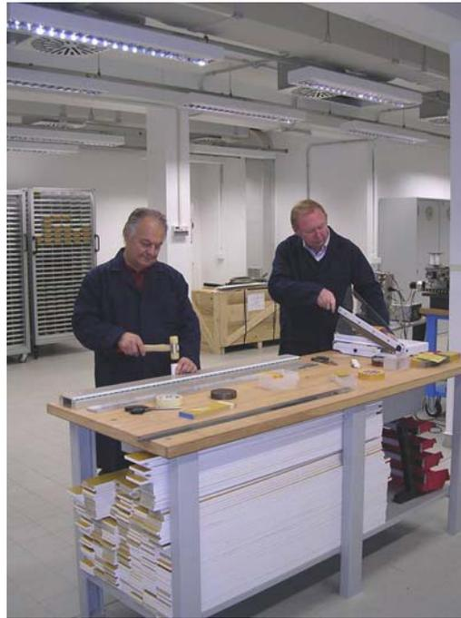
**Figura 3.17:** Inserimento dei pin di plastica nel PCB-bottom e preparazione delle strisce di mylar e nastro biadesivo.
