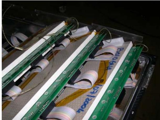
**Figura 4.27:** Supporti in Delrin per fissare le MRPC ai piani in plexiglass.
