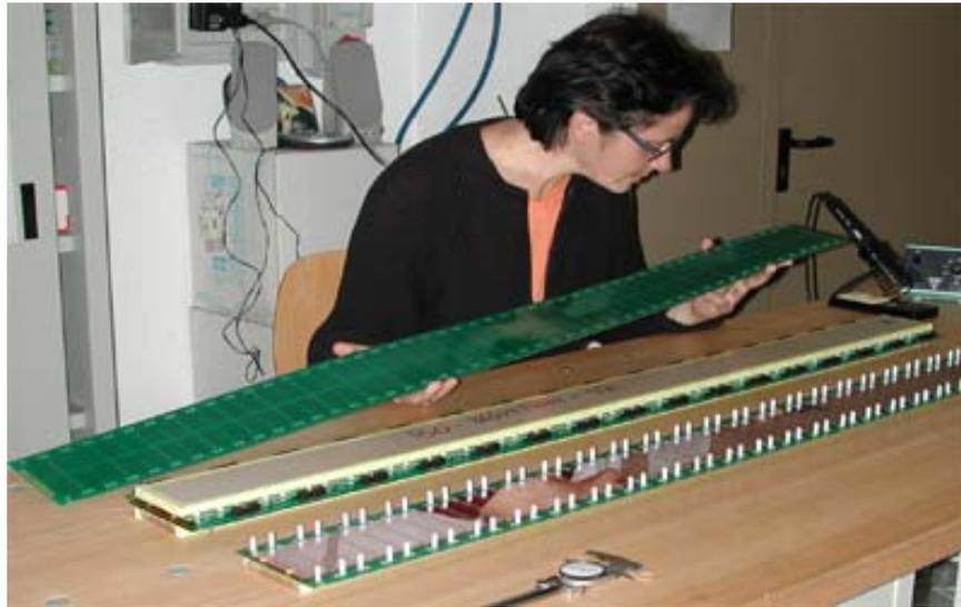
**Figura 3.16:** MRPC aperta: sono visibili i vetri interni spaziati dal filo da pesca, il vetro con la pittura acrilica rossa e le viti per fissare il filo da pesca. MRPC finita, dopo le saldature.
