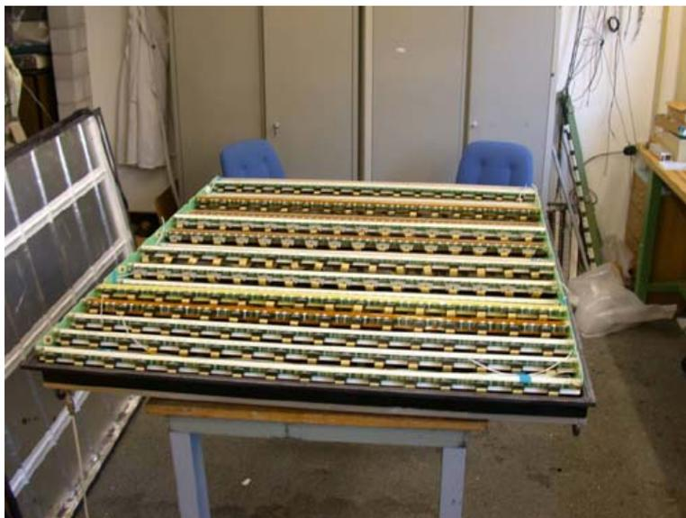
**Figura 4.25:** Foto del primo prototipo di modulo intermedio con tutte le 19 MRPC al suo interno.
